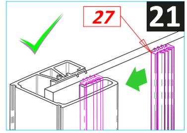
Poz Nr.= 27 Cam Sıkıştırma Fitolini geçici olarak 15 - 20cm kadar yerleştirin.
